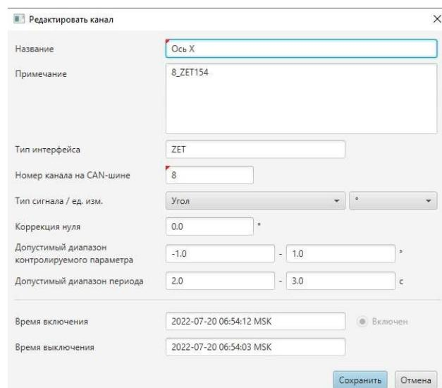
Как следует из инструкции к датчику, он содержит две взаимно ортогональных оси: X,Y с данными по углу наклона. Настройка номеров каналов CAN шины, расположение осей в пространстве и при установке подробно описаны в документации к датчику и не являются частью настоящей инструкции.
