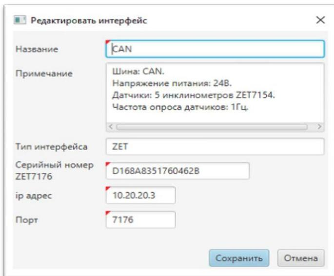
Требуется правильно установить серийный номер преобразователя ZET7176 (если номер окажется введен некорректно сбор данных с датчиков производиться не будет), IP адрес преобразователя и порт. Уточнить эти параметры можно в документации к соответствующему устройству. Установить или изменить параметры преобразователя можно с помощью ПО от разработчика преобразователя.
