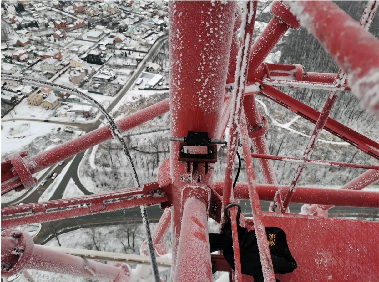
Рисунок 5. Датчик, закрепленный на поясе башни в процессе измерения на отметке +140.000 м.
